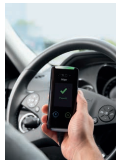
4. Resultado de la prueba favorable: Desbloqueo del motor
